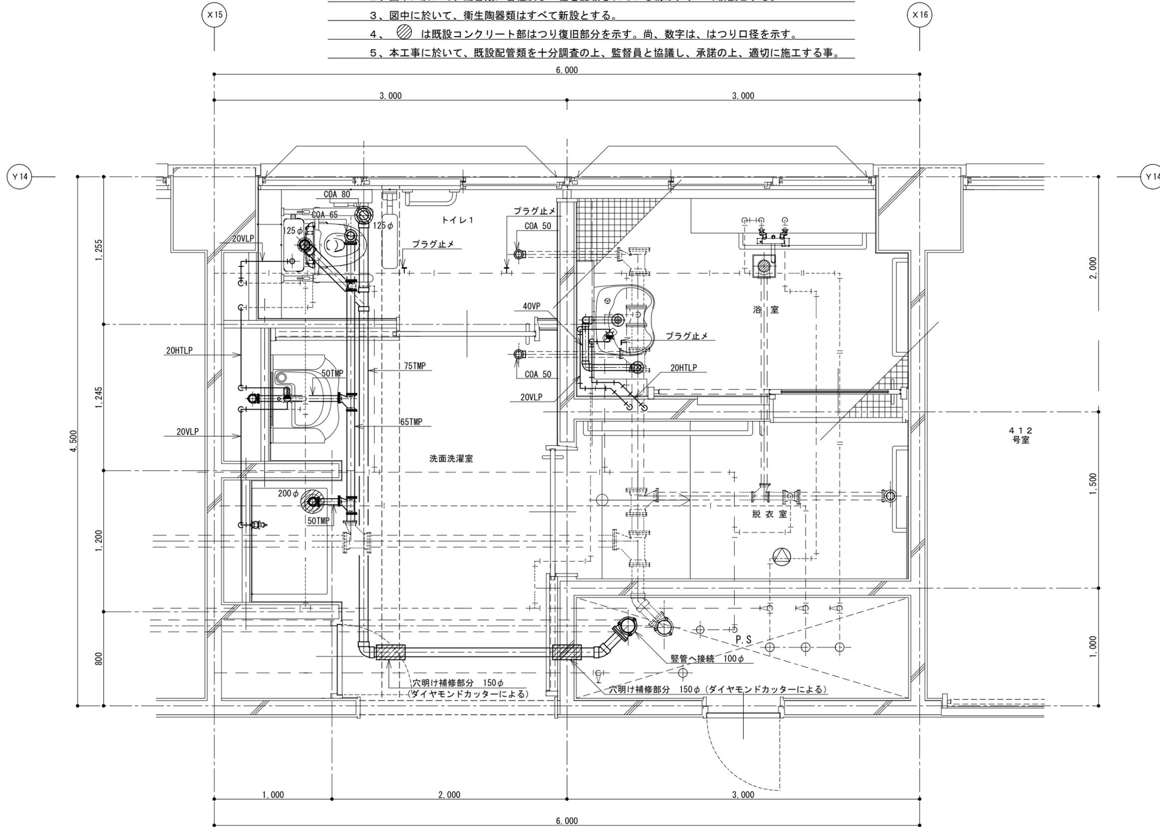
給排水衛生設備 4階東病棟トイレ1・洗面洗濯室・浴室 新設平面詳細図 S=1:30
