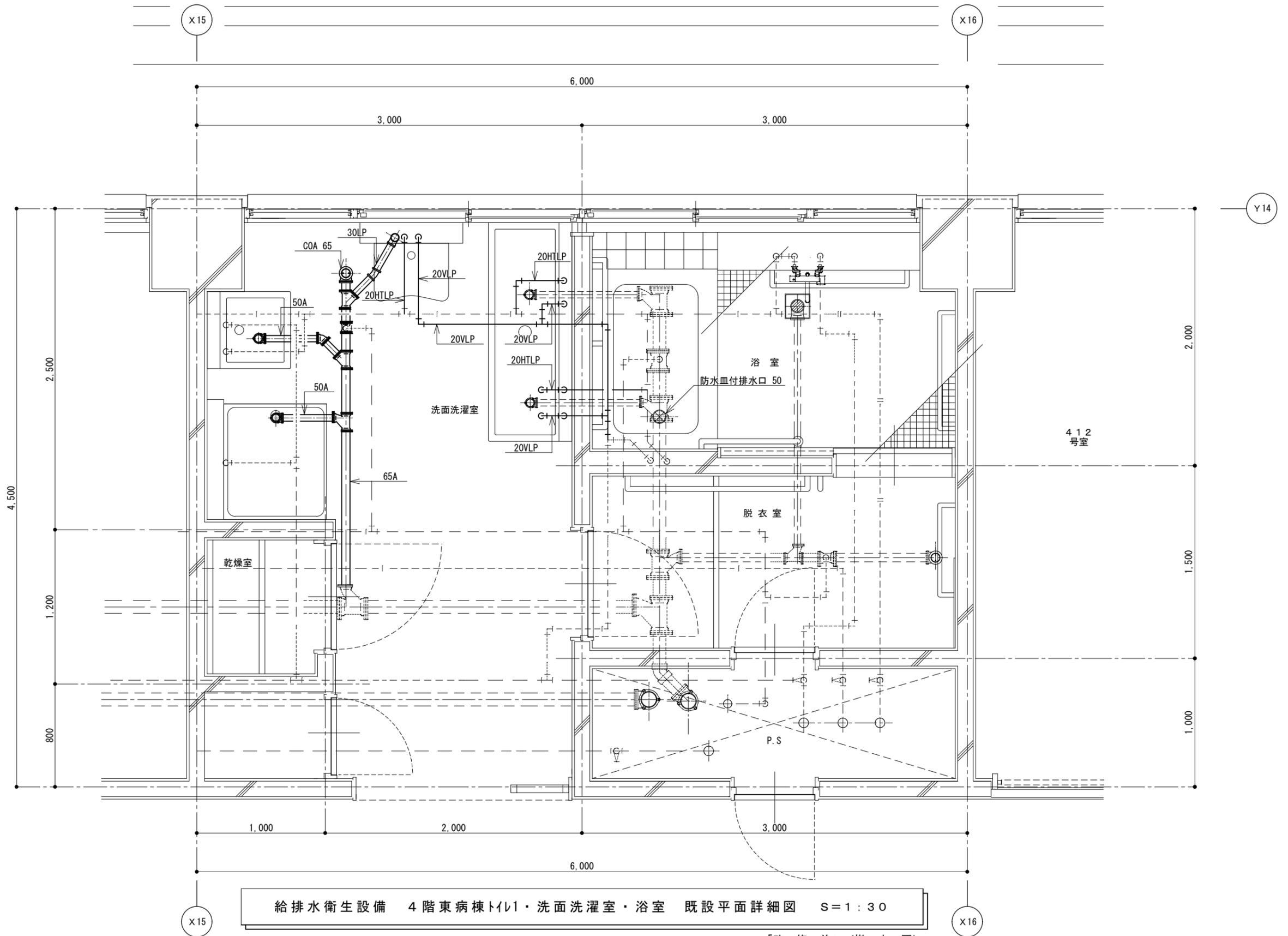
給排水衛生設備 4階東病棟トイレ・洗面洗濯室・浴室 既設平面詳細図 S=1:30
